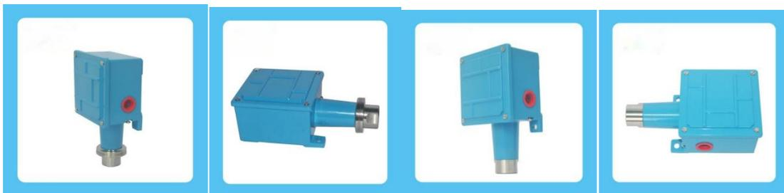
**PS110 金属膜片 0.16MPa 系列:** 316L 不锈钢膜片, NPT1/2F 压力接口 (其他接口可订制), 防爆产品型号后面加 “-E”
